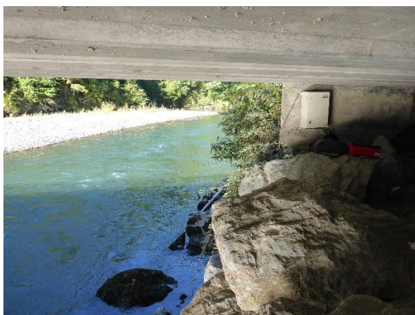
Exemple d'installation de sondes de suivi MES
