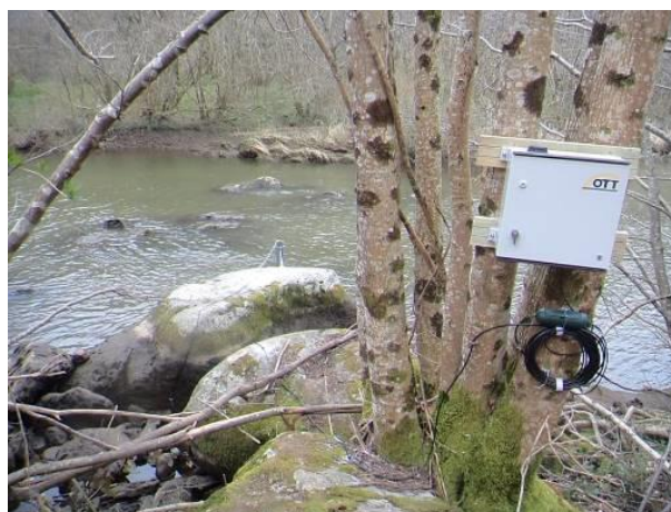
Exemple d'installation de sondes de suivi MES
