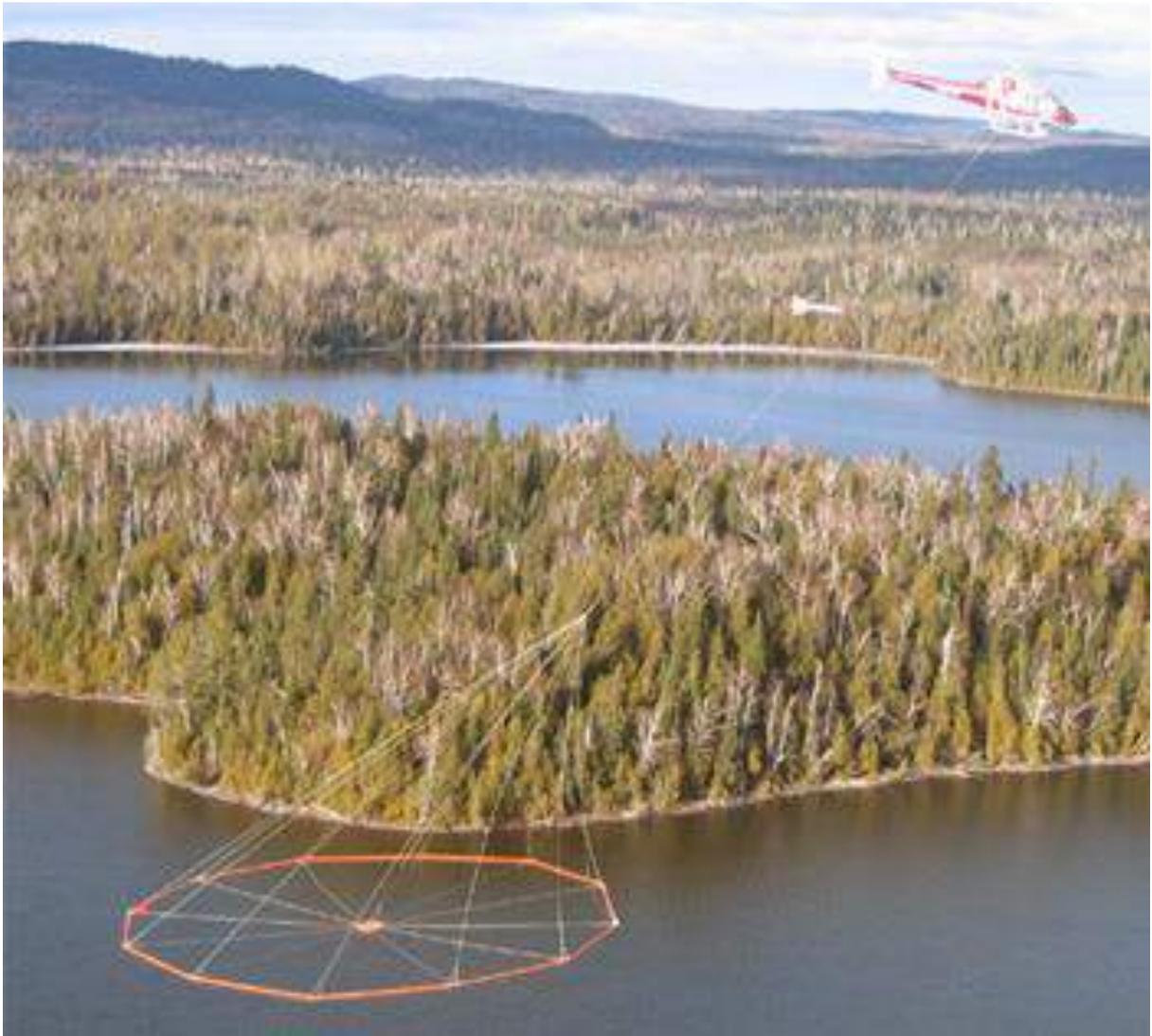
Emploi du VTEM au Canada ; vue du capteur (boucle) héliporté à une altitude de 50 m.
