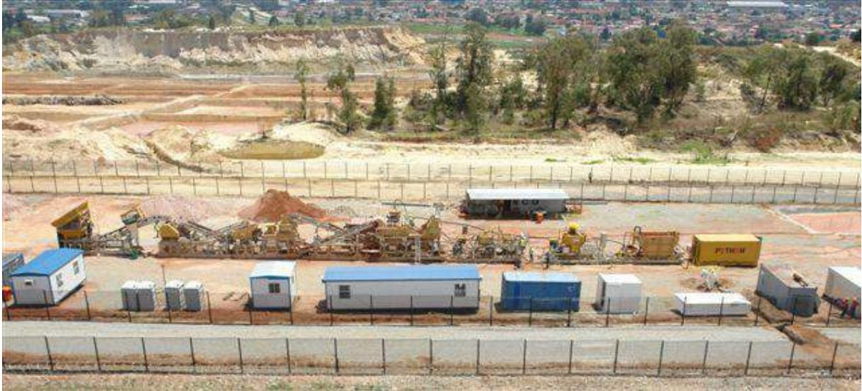
Schéma de l'installation industrielle mobile de type Gekko Python 500 (50 tonnes/heure de capacité).
