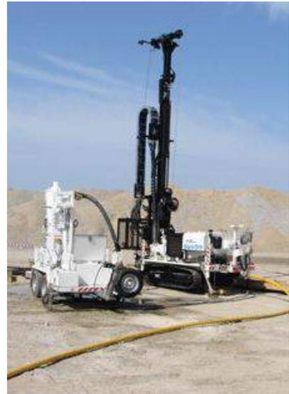
**Figure 3 : Foreuse à circulation inverse**
