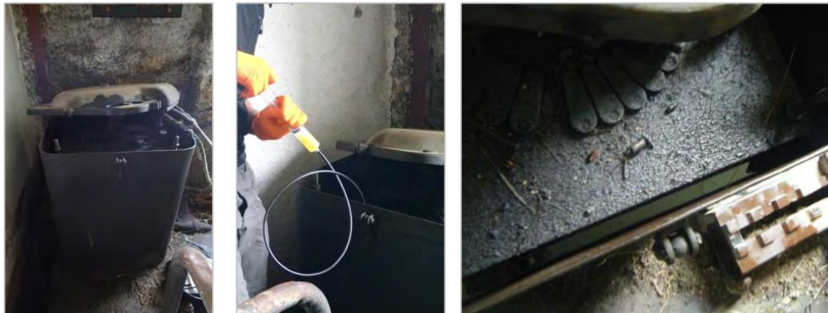
Echantillonnage des huiles contenues dans la cuve C1 (moteur d'entraînement du compresseur) avec tuyaux flexible et seringue. Au droit du poste du compresseur de Bentaillou.
