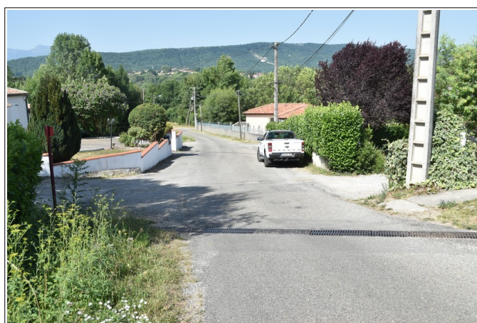
Figure 3.20: chemin de la Serre par lequel peuvent se propager les écoulements du talweg du château d'eau.
