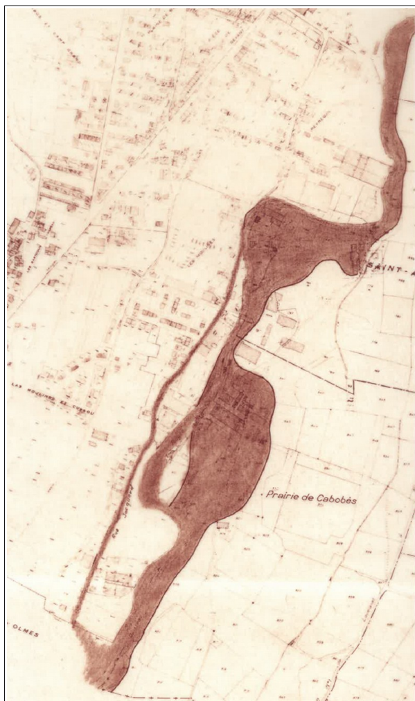
Figure 3.1: champ d'inondation de la crue de 1977 au niveau de Lavelanet (sud de la commune).
