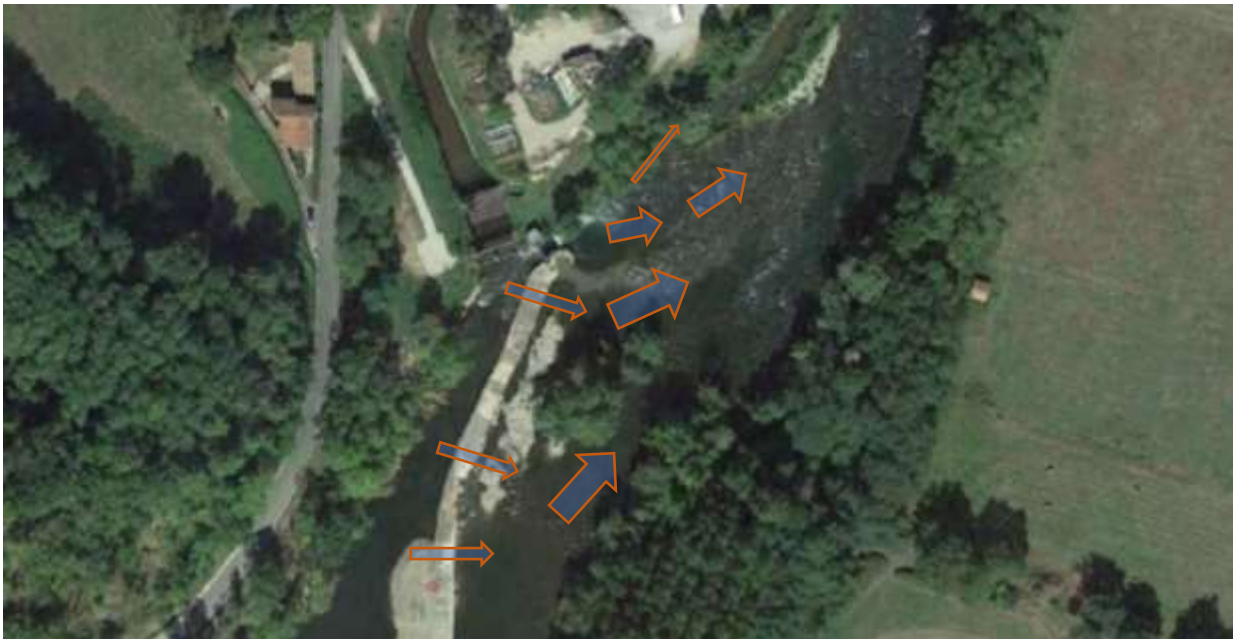
Écoulements dominants vers le bras principal en sortie de vanne de décharge
