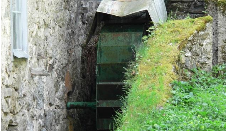
La roue à aube qui entraîne la rotation de polisseuses
