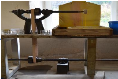
Courroie principale avec système de transmission qui change la direction
